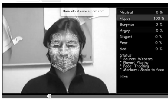
Figura 1: eMotion. Um sistema de classificação automático de emoções. Do lado direito da tela, as seis emoções básicas e mais o estado neutro são apresentadas em variações de 0 a 100%.
